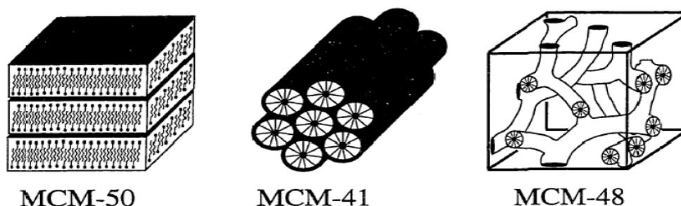
**Figura 1.5.-** Diferentes estructuras de los materiales de la familia MS41. MCM-50 (laminar), MCM-41 (hexagonal) y MCM-48 (Cúbica) [75].
