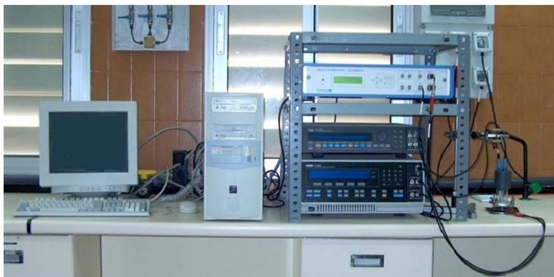
**Figura 2.10.-** Instalación completa de medidas electroquímicas.
