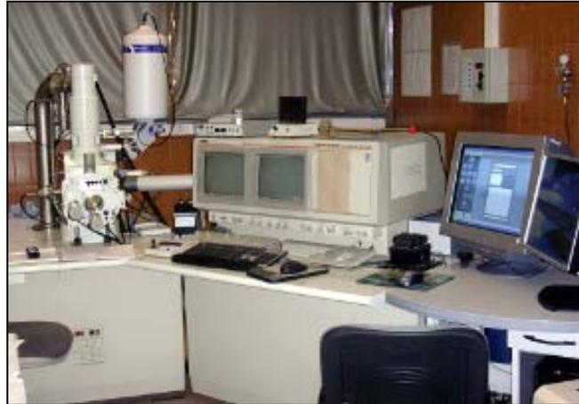
**Figura 2.5.-** Equipo utilizado para realizar el análisis de microscopía electrónica de barrido (SEM) [32].
