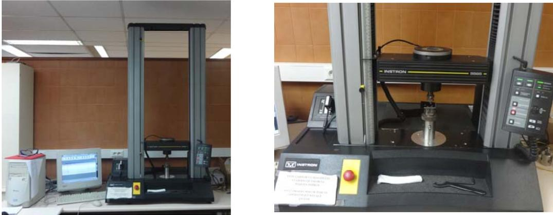
**Figura 2.12.-** Instalación para las medidas de flexión por tres puntos.
