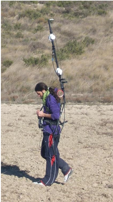
Fig. 10.- Magnetómetro móvil. Empezando por arriba, se encuentra el GPS y posteriormente los dos sensores.
