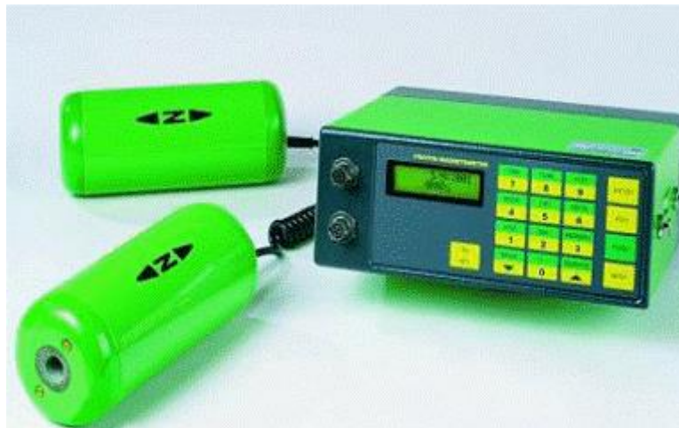
Fig. 9.- Magnetómetro PMG2 de SastisGeo utilizado como base de referencia.
