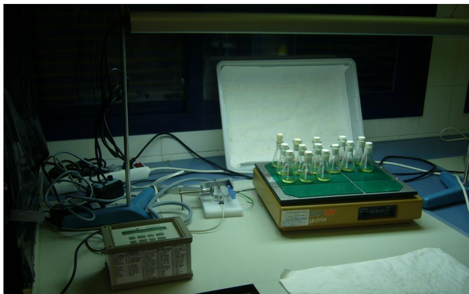
Fotografía 3. MINI-PAM II (derecha) junto con muestras de plata con algas, dispuestas para ensayo
