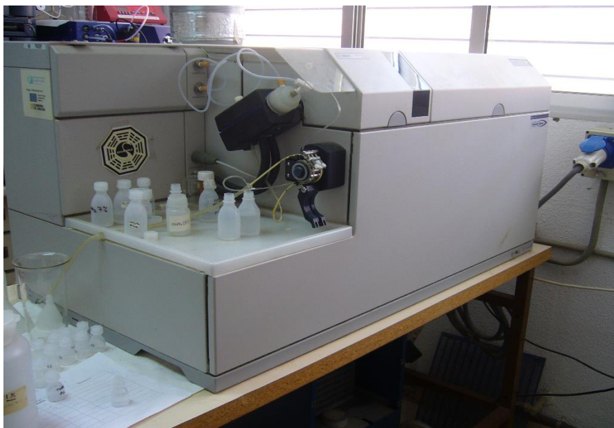
Fotografía 4. Equipo ICP-MS, localizado en el CPS (Zaragoza)
