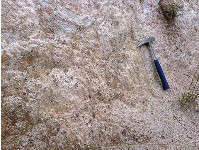
FIG. 8. Aspecto de la harina de falla totalmente pulverulenta en Los Abuelos.
