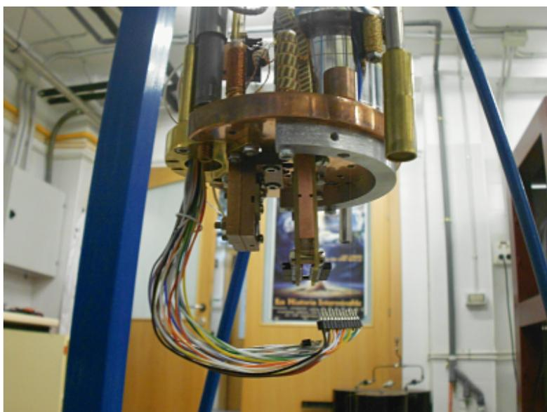
Figura 7: Refrigerador de dilución del Laboratorio de Bajas Temperaturas de Zaragoza.
