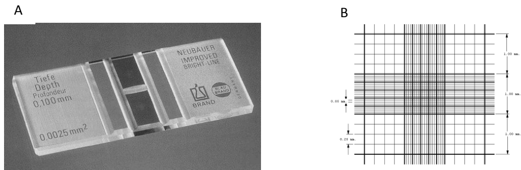
Figura 13: A. Cámara de Neubauer. B. Representación de la cuadrícula marcada en la cámara.
