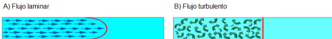
Figura 1. Diagrama de flujo laminar con su perfil de distribución de velocidades (A), diagrama de flujo turbulento con su perfil de distribución de velocidades (B).
