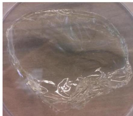
*Figura 6. Película de quitosano sintetizado a partir del método de evaporación del solvente.*
