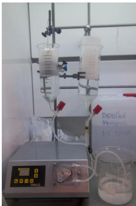
*Sistema de vasos comunicantes y bomba peristáltica utilizado para llevar a cabo el dip-coating.*
