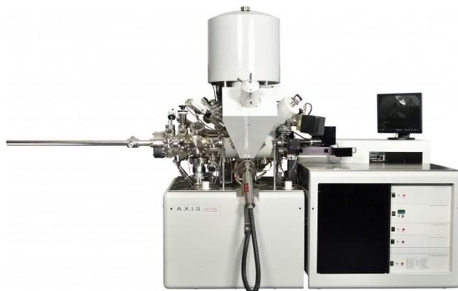
*Espectroscopio de fotoelectrones emitidos por rayos X
