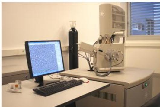
*Microscopio electrónico de barrido modelo HITACHI S2300.*
