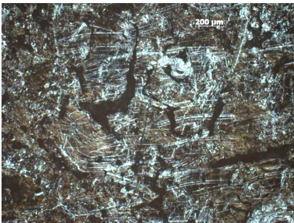
FIGURA 22. OBSERVACIÓN DE ARAÑAZOS SOBRE LA MUESTRA RECOCIDA A 1000°C Y 10% HR, DURANTE 4h.
