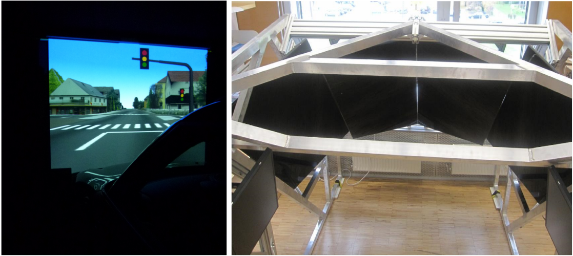
Figura 1.3.: Ensayo con un proyector de cómo y dónde se formará la imagen (izquierda), estructura y pantallas 3D que se montarán enfrente del simulador y en ambas ventanillas para crear el efecto 3D y efecto de velocidad (derecha).
