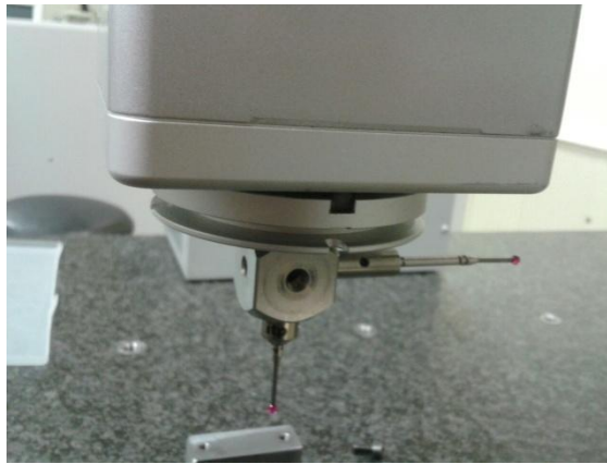
FIGURA 12. CONJUNTO DE PALPADORES EMPLEADO PARA MEDIR LAS PIEZAS A
