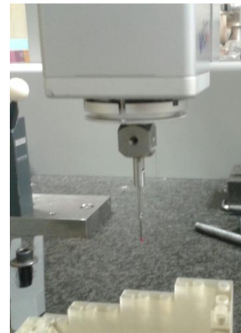
FIGURA 21. PALPADOR VERTICAL PARA MEDICIÓN DE PIEZA B
