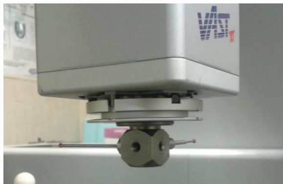
FIGURA 268. PALPADORES NÚMERO 2 Y 3 PARA MEDICIÓN DE PIEZA B
