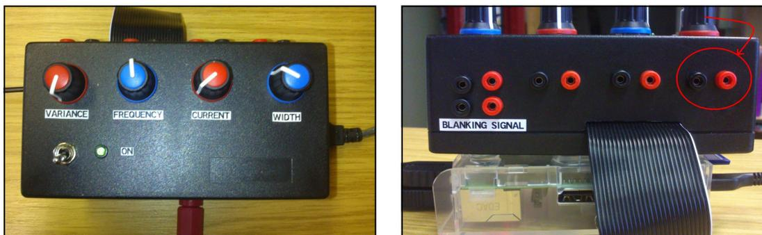
Fig 9. Apariencia final del controlador con sus cuatro potenciómetros, el botón de inicio y las salidas en la parte trasera que facilitan la lectura de información en caso de que sea necesario.
