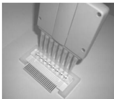
Figura 13: Modo de trabajo con pipeta multicanal sobre los electrodos múltiples CH8 [202]
