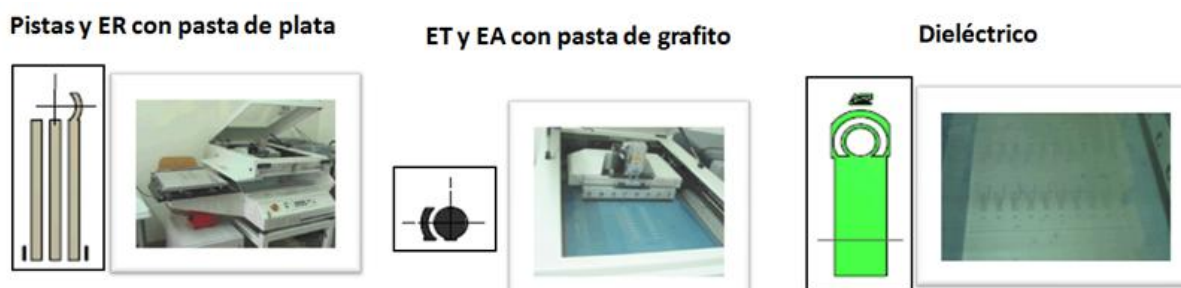
Figura 12: Esquema de los pasos necesarios para producir un SPCE
