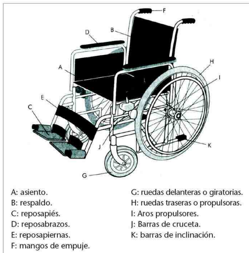
Figura 1. Partes principales de una silla de ruedas manual plegable.
