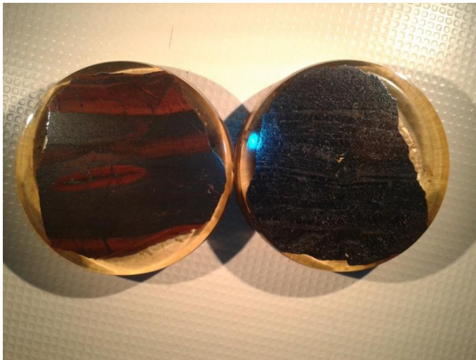
Fig.17 Comparación de probetas Tcha-5 y Tcha-4. Esta última, reemplazamiento total por hematites
