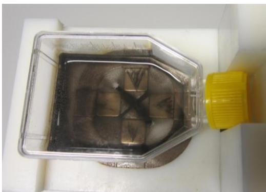
*Figura 21. Prueba con ferrofluido para comprobar la dirección de las líneas de campo*
