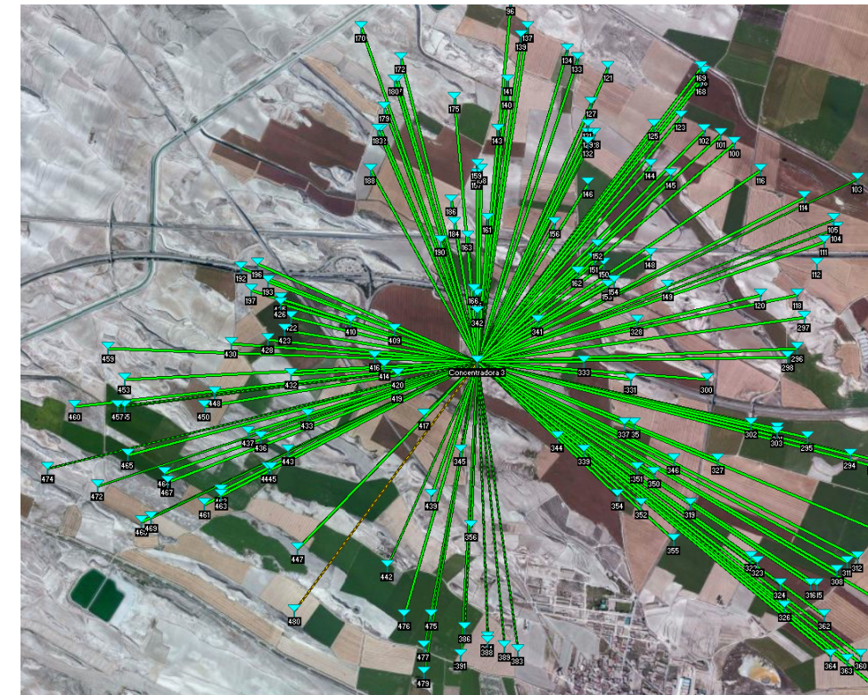
Figura 21: Radioenlaces existentes con la 3ª unidad concentradora
