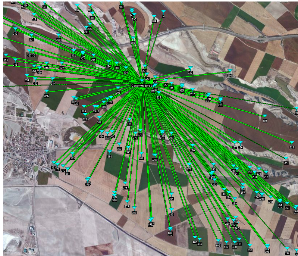
Figura 17: Radioenlaces existentes con la 2ª unidad concentradora
