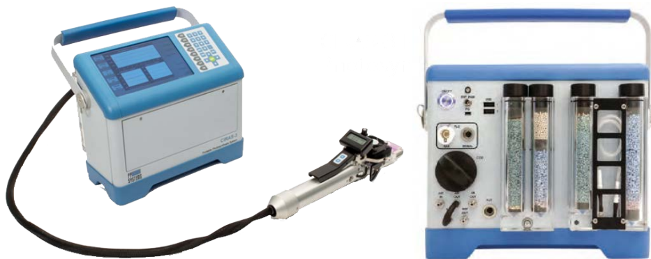
Figura 2 – Ciras 3, Medidor de transpiración y fotosíntesis de PP-Systems.
