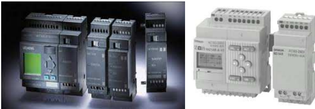
Ilustración 28: Microautómata SIEMENS LOGO a la izquierda y OMRON ZEN en la derecha
