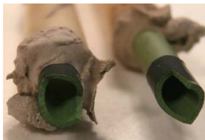
Figura 41. Pila rota durante el montaje. Tenía una micro grieta interna que se ha ido extendiendo hasta su rotura.
