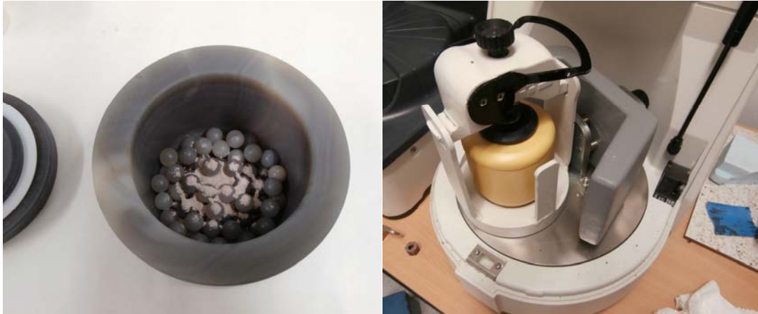
Figura 8. Bol y bolas de ágata con polvo antes de añadir etanol para proceder a su mezcla-molienda. Figura 9. Bol de circona colocado y asegurado en el molinillo planetario antes de empezar la molienda.
