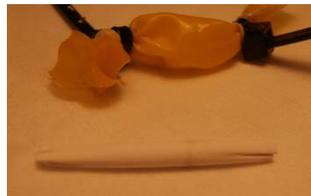
Figura 24. Compacto de LSO después de CIP para muestra de dilatometría.
