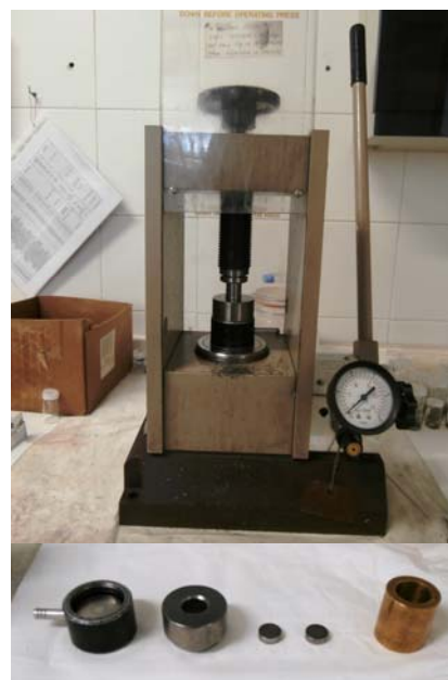
Figura 57. Prensa uniaxial hidráulica y elementos del troquel utilizado.
