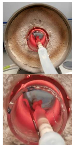
Figura 44. Horno tubular de medida. Detalle del interior.
