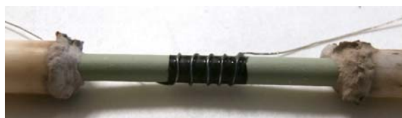
Figura 42. Contactos eléctricos montados en la pila
