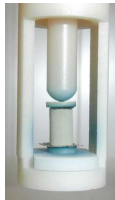
Figura 30. Muestra de ánodo colocada en dilatómetro.
