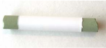
Figura 32. Muestra después de realizar dip-coating (teflón retirado).
