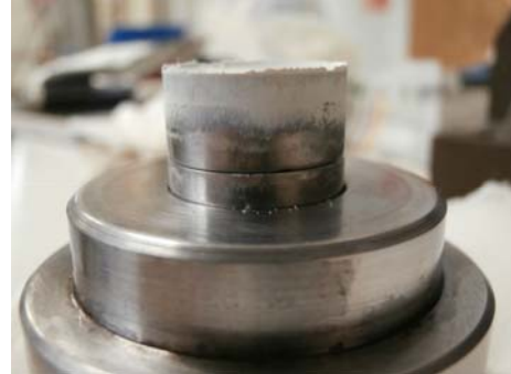
Figura 11. Pastilla recién prensada adherida al troquel lista para su extracción.
