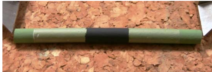
Figura 39. Aspecto de una pila después de la integración del cátodo.
