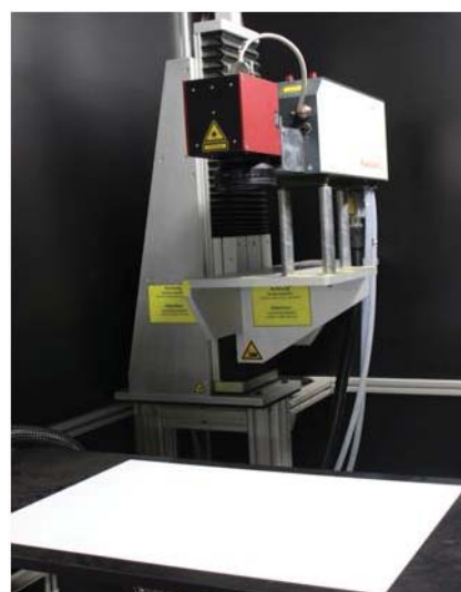
Figura 3.10 Equipo láser Rofin PowerLine E25 y detalle del cuerpo y cabezal
