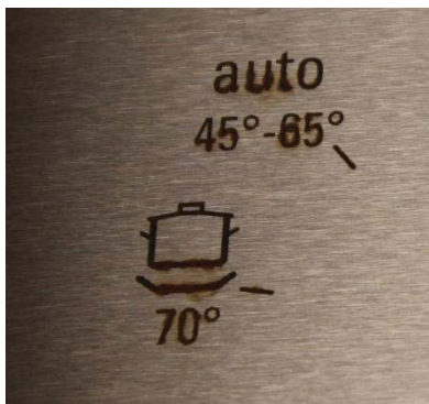
Figura 4.4 Ejemplo de corrosión de marcas tras test de vapor
