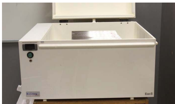
Figura 3.15. Cámara de vapor de la sección de lavavajillas
