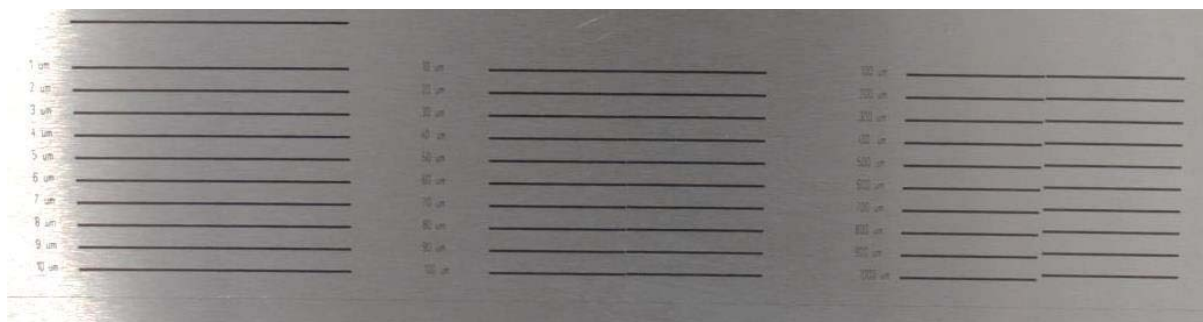
Figura 3.6. Probeta de errores en los dos ejes del campo de marcaje. Rango de 1-10, 10-100 y 100-1000 micras.
