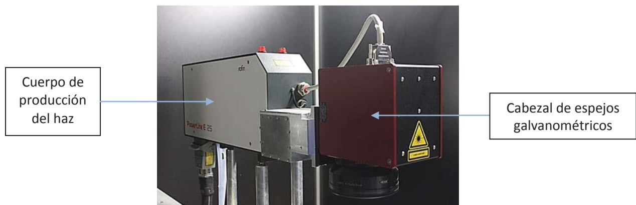
Figura 3.5. Partes diferenciadas de la óptica de un equipo láser
