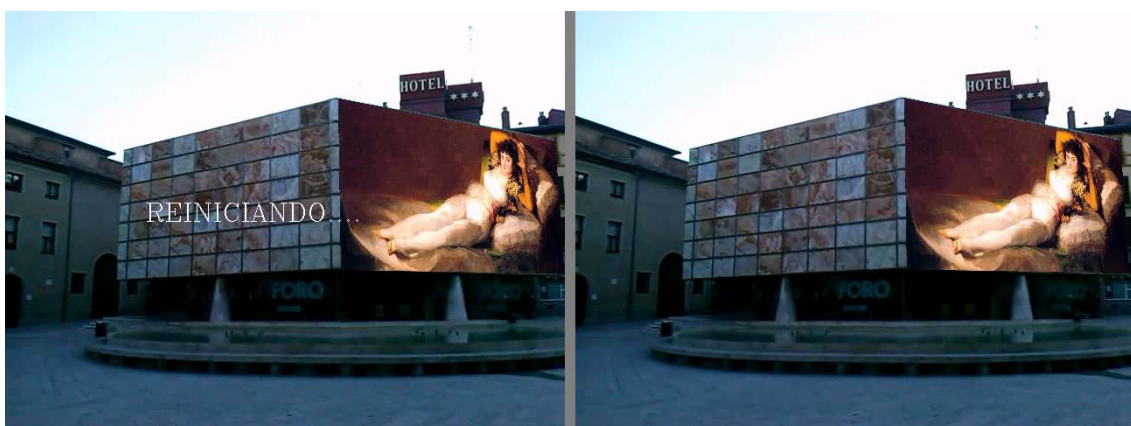
Figura 8: Proceso de inicialización. Se buscan puntos SIFT para detectar la superficie de proyección. Si la zona de proyección no es visible completamente (parte izquierda de la figura) se sigue buscando el momento en que lo sea (parte derecha de la figura). A partir de ese instante el tracking KLT puede comenzar normalmente.
