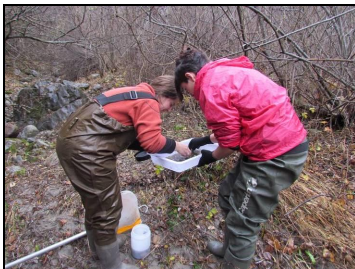
Figura 35. Detalle del procedimiento de vaciado de la red (o salabre) con macroinvertebrados en las bateas (bandejas blancas) antes de su introducción en botes herméticos (abajo en la figura).
