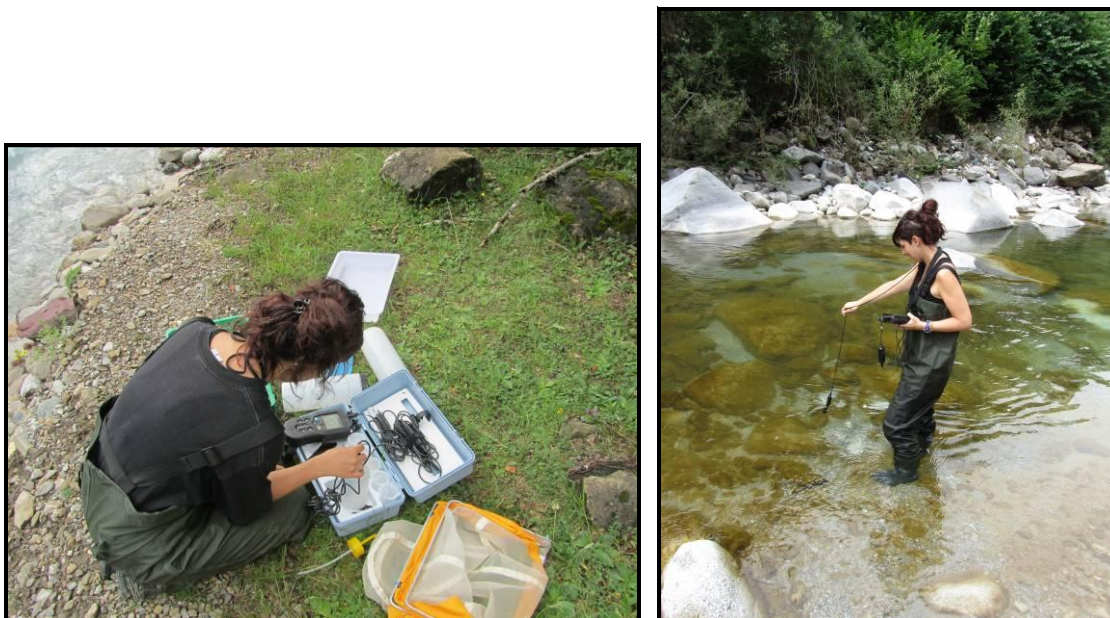
Figura 29. Detalle de la sonda multiparamétrica (izquierda) y muestreo in situ de los parámetros físico-químicos en el punto C.3 "Salinas" (derecha) durante el muestreo de verano en el río Cinca.
