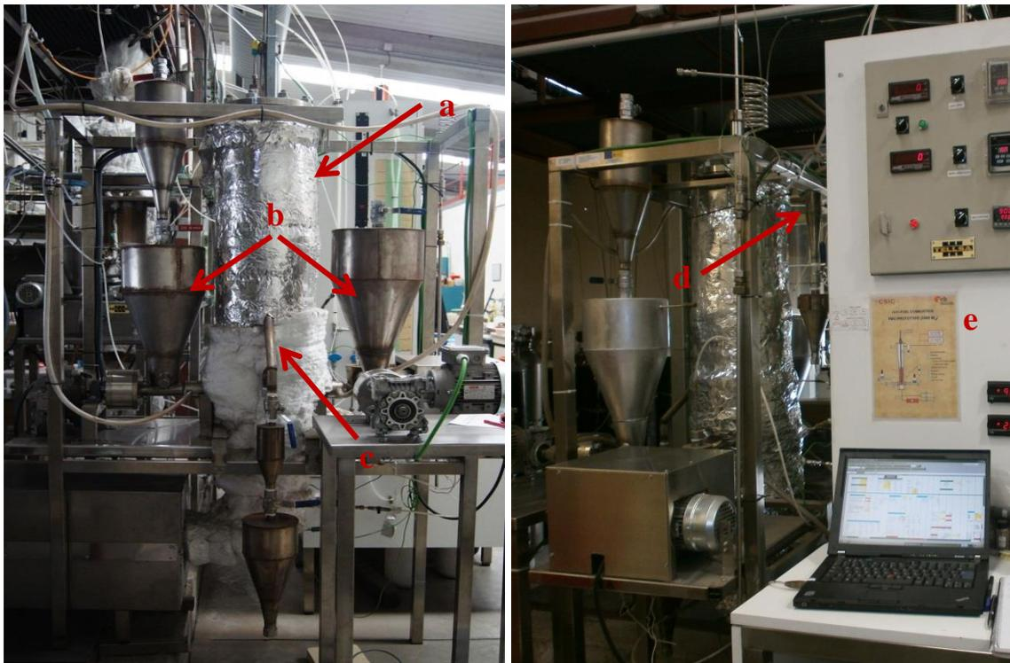
**Figura 4.2.** Vista general de la instalación. a) Combustor, b) tolvas de sólidos, c) rebosadero, d) ciclón y e) control y adquisición de datos.
