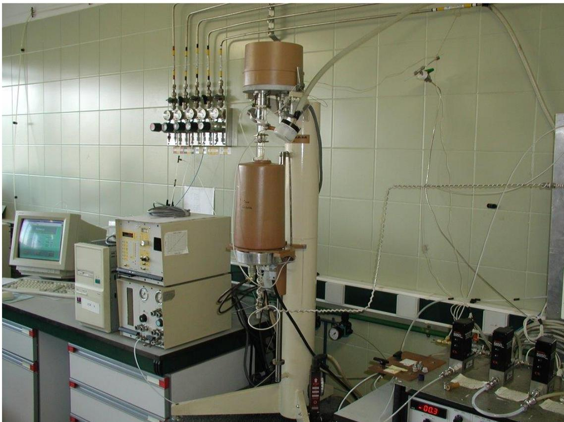
**Figura 2.7.** Termobalanza Setaram TGC-85 y sistema de válvulas y controladores de flujo másico.
