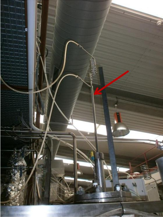
**Figura 4.3.** Intercambiador de calor
