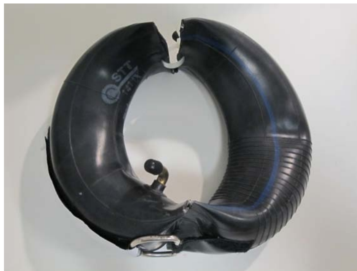
Figura 6: Primer dispositivo preliminar realizado, empleando cámara de aire de rueda de carretillo. Se puede observar el sistema de correas que permitía ajustarlo a la cuartilla de la extremidad de los caballos del estudio.
