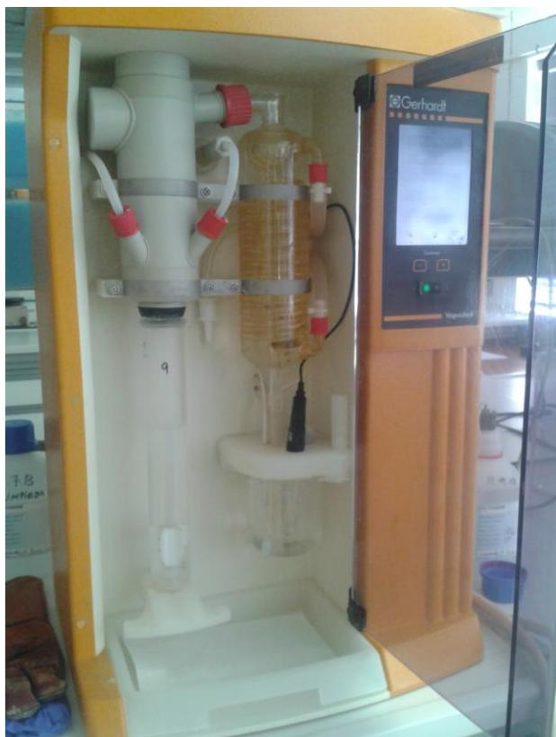
Figura 10. Equipo de destilación Kjeldahl
