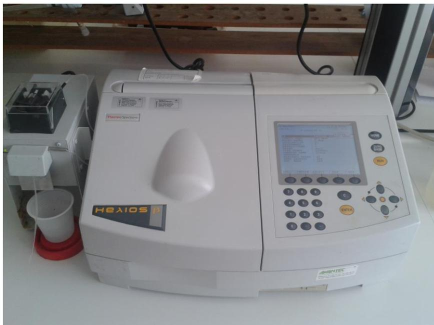
Figura 11. Foto del espectrofotómetro
