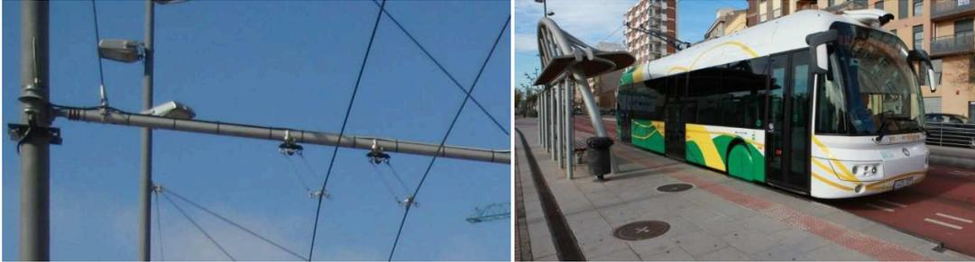
Figura 1.18 – Catenaria con sistema de péndulo del trolebús de Castellón
