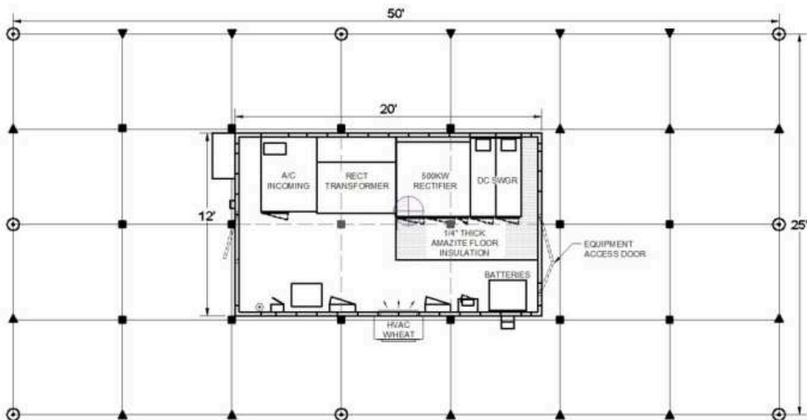
Figura 2.6 - Plano en planta de una subestación típica
