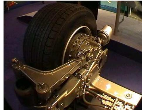
Figura 1.14 - Motor HUB montado (Trolebús modelo Cívica)
