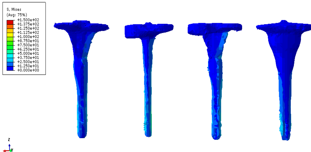
Figura 3.20. Tensiones de Von Mises en el implante (MPa). Vista trasera. a) Prótesis en offset sin suplemento. b) Prótesis con vástago recto. c) Prótesis en offset con suplemento. d) Prótesis con vainas
