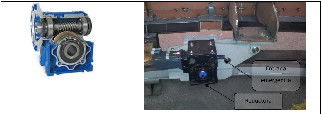
Fig.2.2.1.1 – Reductora del tipo sin-fin corona
