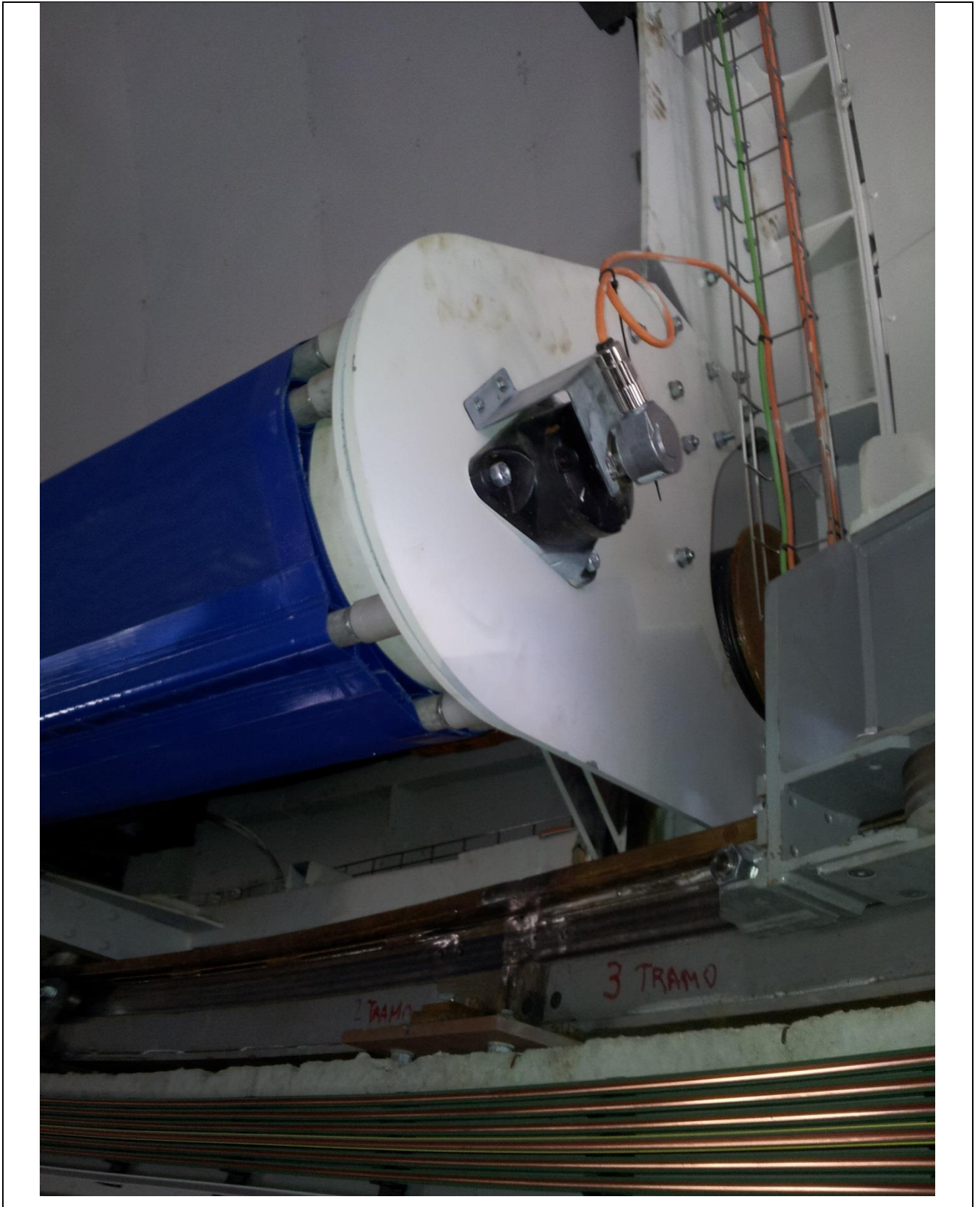
Fig. 2.4.5.3 – Instalación SICK SFM60-HMAB0K02
