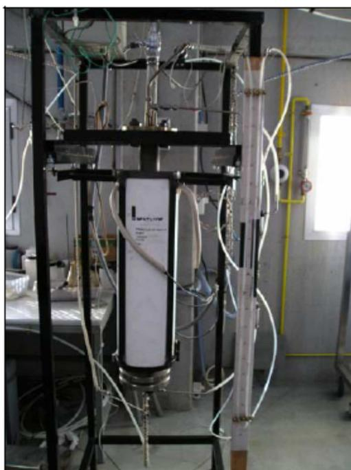
Figura 2 – Imagen del reactor de lecho fluidizado discontinuo
