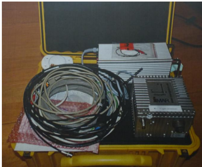
Ilustración 4. Antena GPS, estabilizador de energía e IMU.
