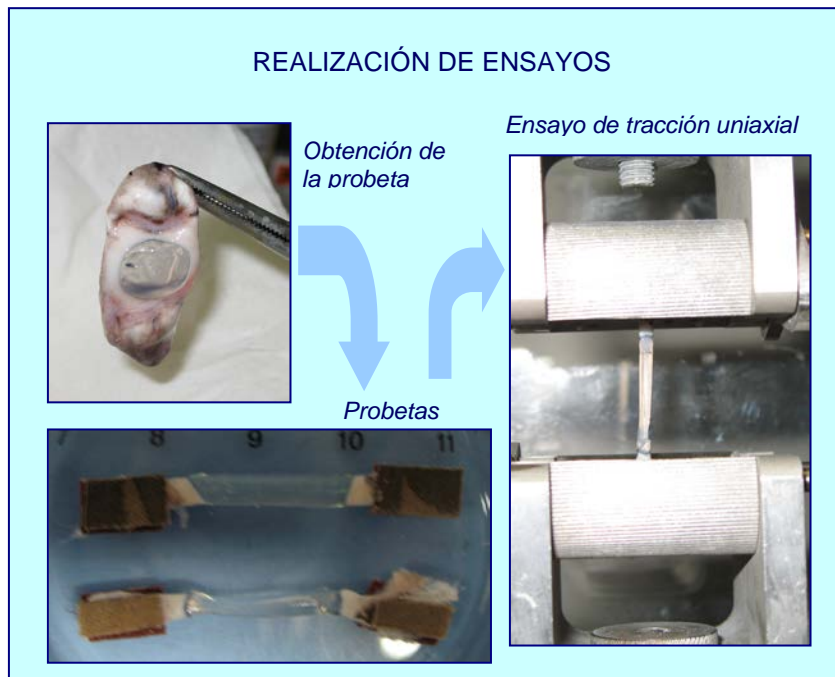
Figura 18: Ensayos de tracción uniaxial en diferentes fragmentos de córnea de cerdo.
