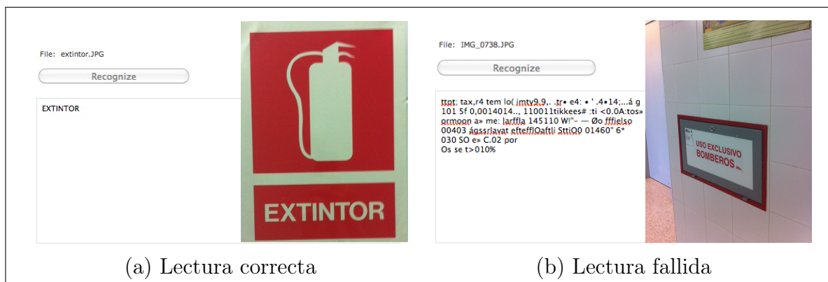
Figura 1.1: (a) Resultados obtenidos por el OCR usando un cartel de cerca, frontal y encuadrado y (b) otra desde una mayor distancia, donde el cartel sufre una deformación debido a la perspectiva
