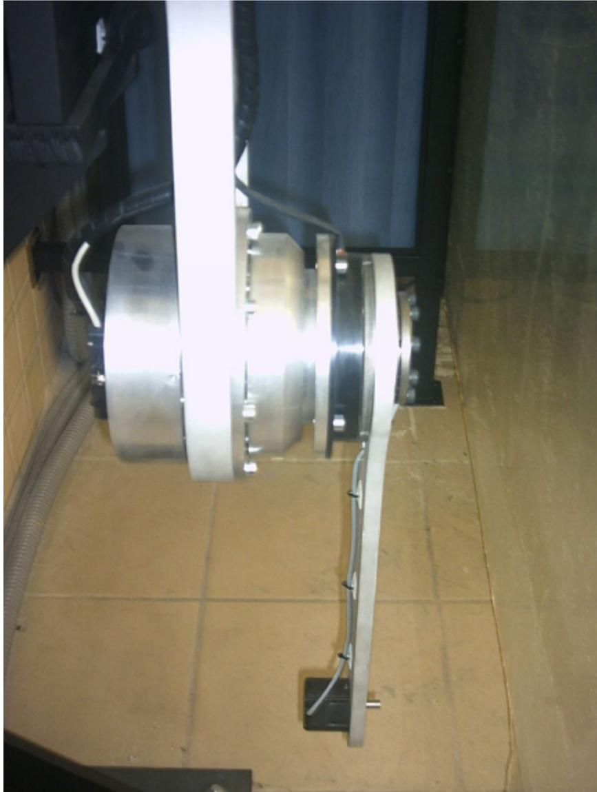
Figura A.5: Detalle del motor del codo y del encoder incremental
