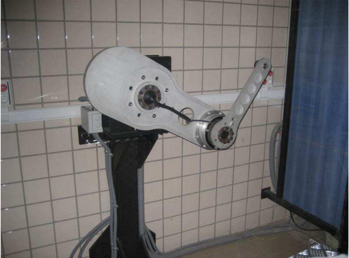
Figura 1.1: Robot de tres grados de libertad en movimiento
