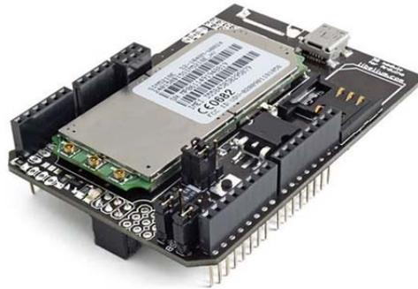
Figura 12: Módulo 3G/GPRS de Arduino, con el chip de comunicaciones SIM5218 de SIMcom montado.
