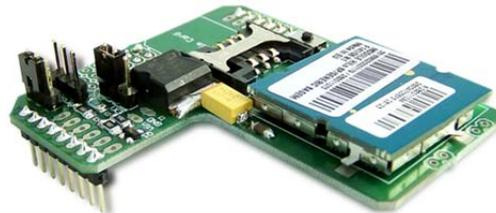
Figura 7: Módulo GPRS de *Cooking-Hacks*, con el chip de comunicaciones *HiLO* de *SAGEM* montado.
