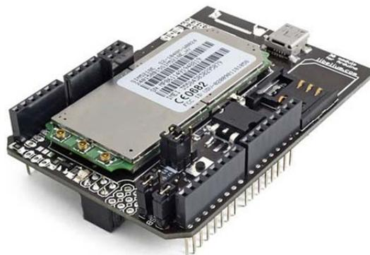
Figura 34: Módulo 3G de Arduino, con el chip de comunicaciones SIM5218 de SIMcom montado.
