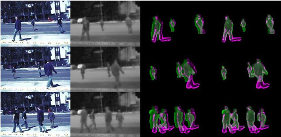
Fig. 28: Certificación estéreo entre luz visible e imágenes térmicas (2). (a) Imagen en color de la entrada, (b) imagen IR térmica de la entrada, (c) superposición desalineada de las imágenes en color e IR antes de la certificación, y (d) superposición desalineada de las imágenes en color e IR después de la certificación
