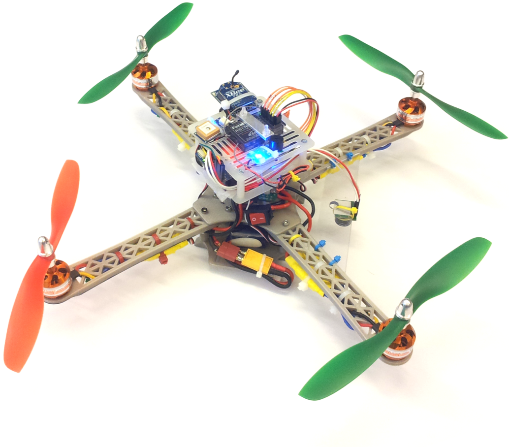
Figura B.6: Cuadricóptero de fabricación propia usado en el proyecto
