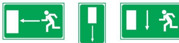
Figura 26: Señales indicadoras de vías de salida
