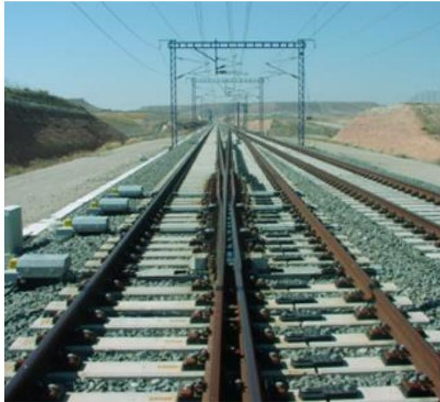
Figura 3. Corazón punta móvil de alta velocidad. Fuente: JEZ.
