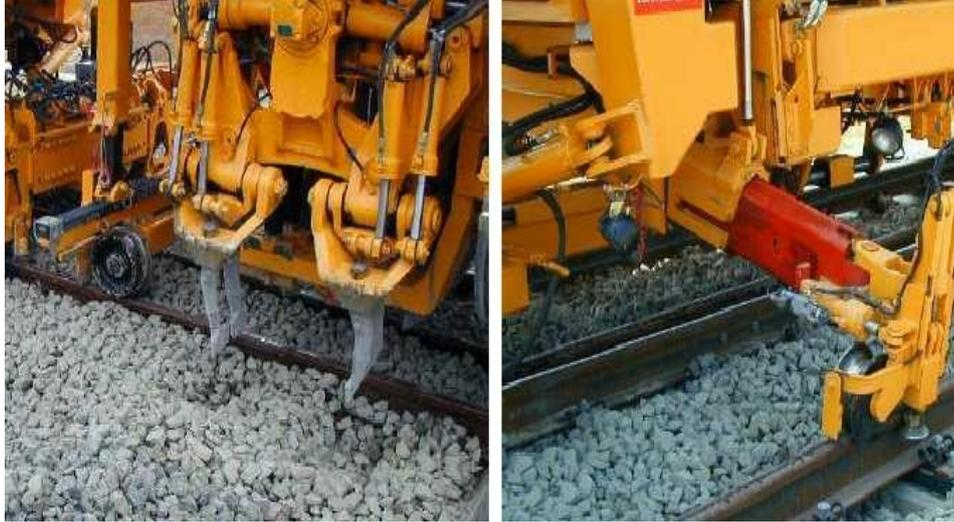
Figura 40. Operaciones de bateo y estabilización de la vía. Fuente: Melendo.
