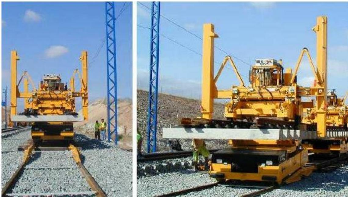
Figura 33. Circulación de los equipos sobre la vía auxiliar. Fuente: Melendo.
