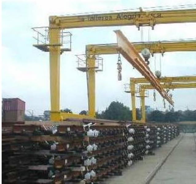
Figura 15. Traslado del material de desvíos para su verificación en fábrica. Fuente: Melendo.
