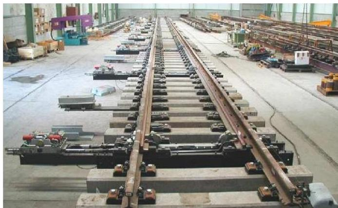
Figura 12. Desvío premontado para verificación en fábrica. Fuente: Melendo.
