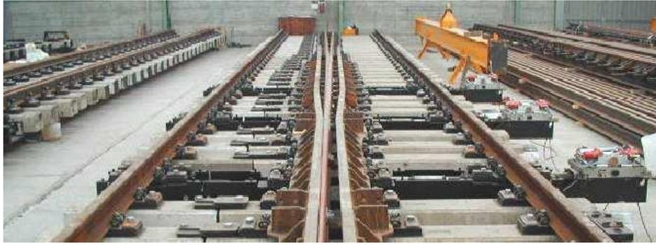
Figura 13. Cruzamiento premontado para verificación en fábrica. Fuente: Melendo.
