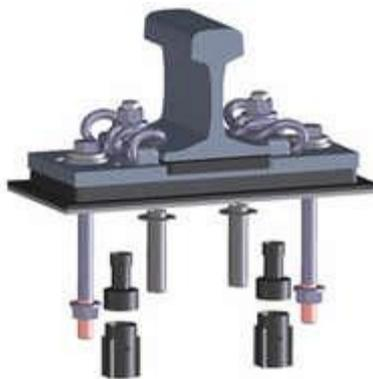
Figura 10. Detalle de fijación PAD. Fuente: JEZ.
