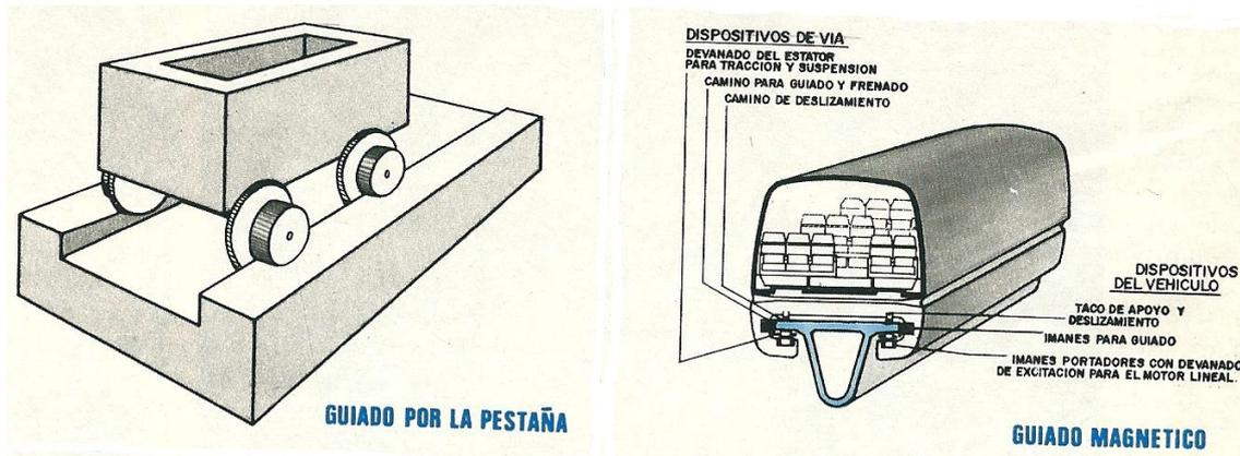
Figura 2. Esquema de guiado por la pestaña y guiado magnético. Fuente: Moreno.
