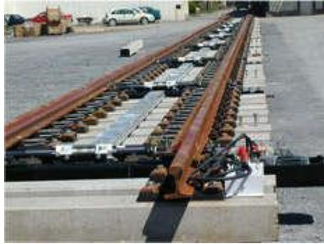
Figura 9. Sistema de accionamiento hidráulico Hydrostar. Fuente: JEZ.
