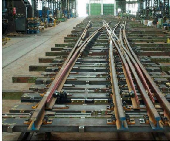
Figura 3. Aparato de vía con anchos métrico, ibérico y UIC. Fuente: Amurrio.
