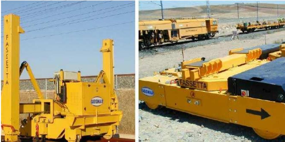
Figura 30. Equipos de pórticos (PEM) y carros sincronizados (LEM). Fuente: Melendo.
