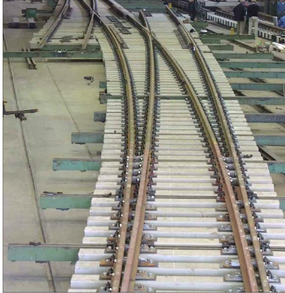
Figura 11. Fabricación de un desvío. Fuente: Alegría.
