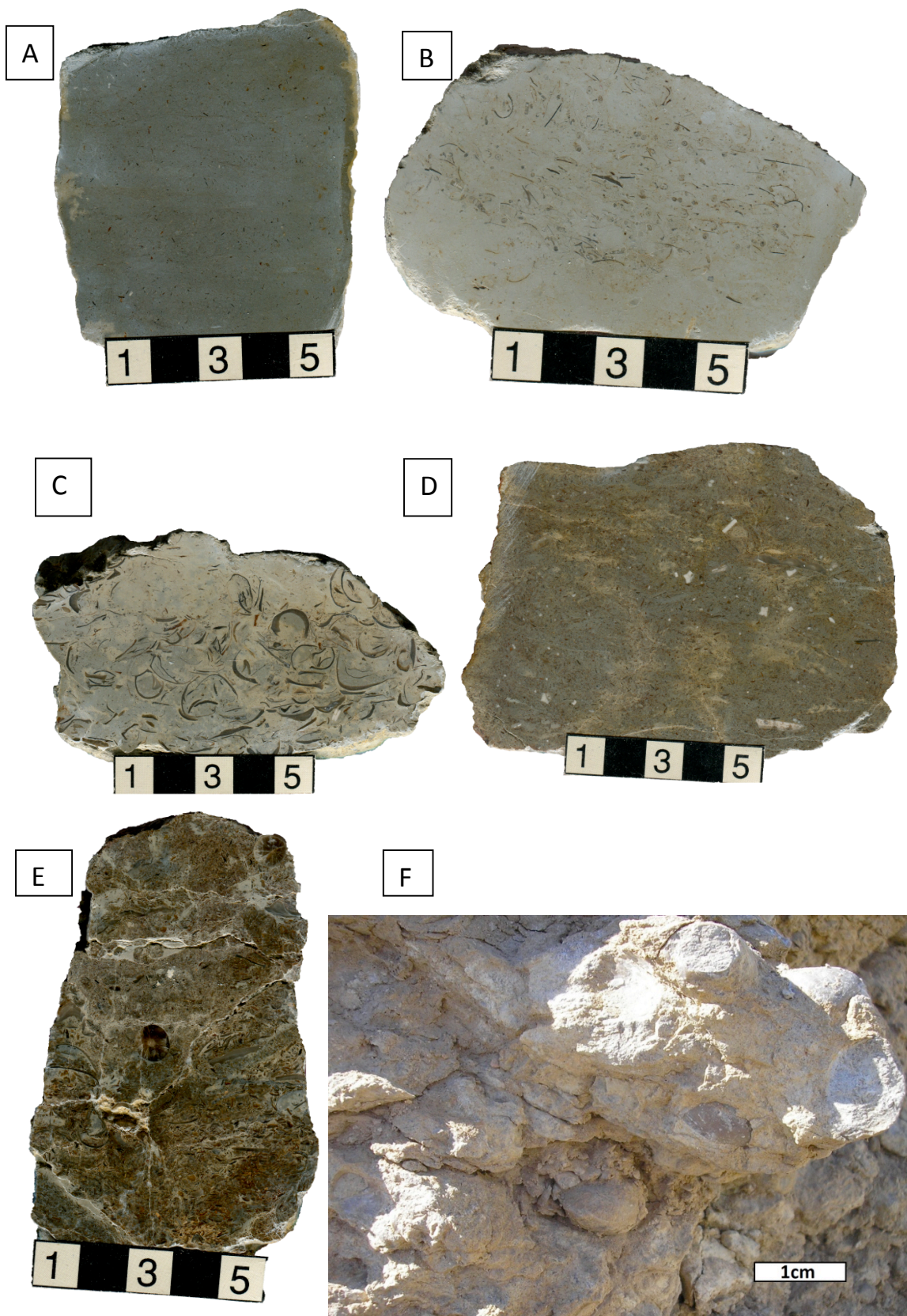
Figura 9. Muestras en sección pulida de las diferentes facies identificadas. A) Facies M-W, subfacies M. B) Facies M-W, subfacies W. C) Facies M-W, subfacies W. D) Facies P, subfacies Pf. E) Facies P, subfacies Pg. F) Facies L.
