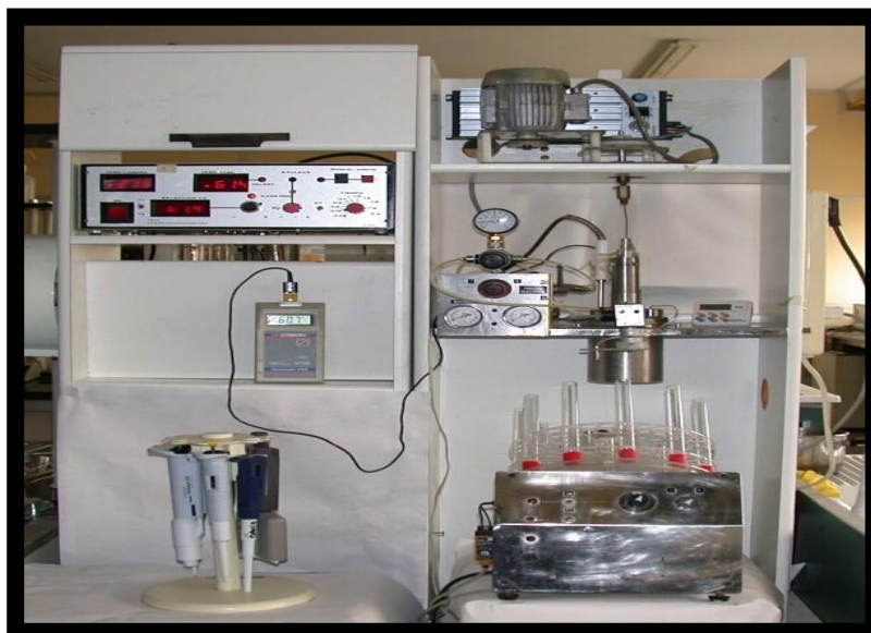
Figura. 7 Termoresistómetro utilizado para las determinaciones de resistencia al calor.
