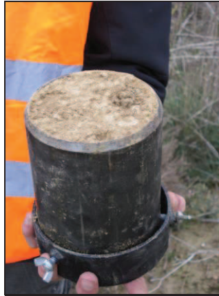
Figura 33. Muestra de suelo para el permeámetro de carga variable.
