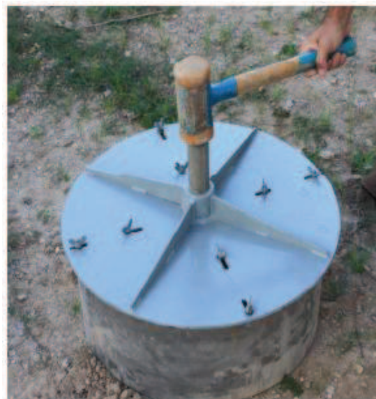
Figura 29. Instalación de los anillos concéntricos sobre el suelo.
