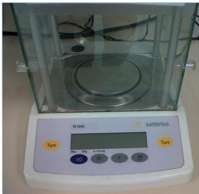
*Figura 5. Balanza de precisión.*
