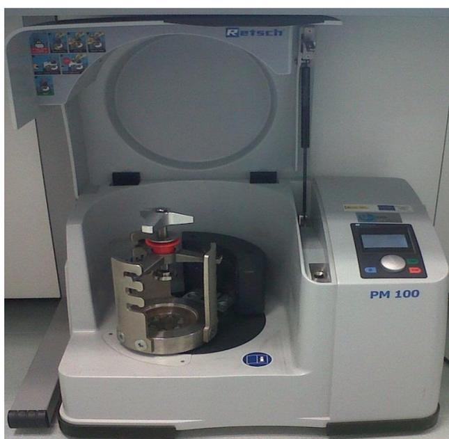
*Figura 6. Molino de bolas (PM100 Retsch).*
