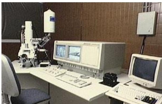
*Figura 18. Microscopio electrónico de barrido (SEM).*
