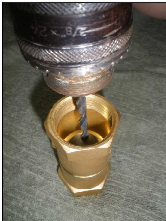
Figura AIII.5. Realizando el orificio final con la broca de 6 mm. [Fuente: Propia]
