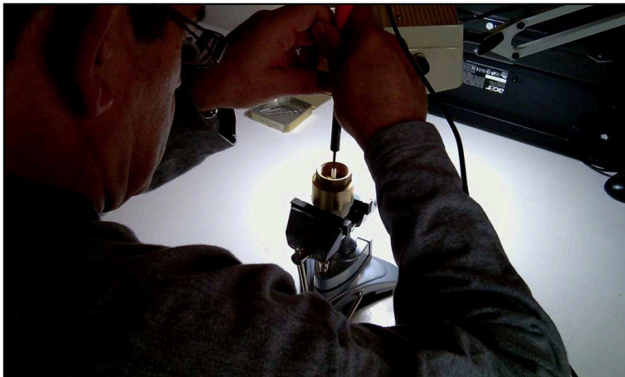
Figura AII.5. Realizando el pequeño agujero con el soldador [Fuente: Propia]
