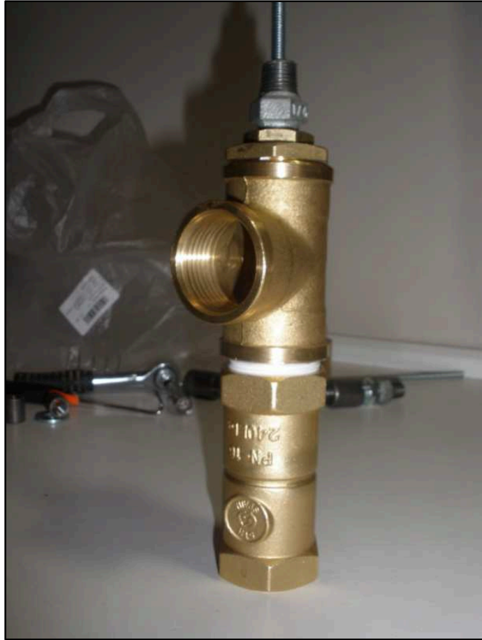
Figura AIII.10. Válvula de impulso modificada de una válvula no retorno tipo Kent [Fuente: Propia]
