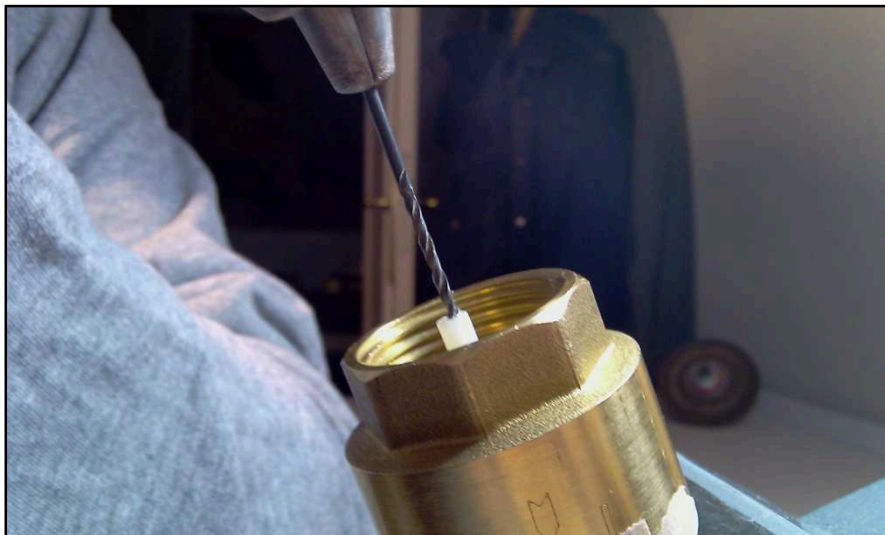
Figura All.7. Realizando la guía para la varilla roscada con una broca de 2 mm [Fuente: Propia]
