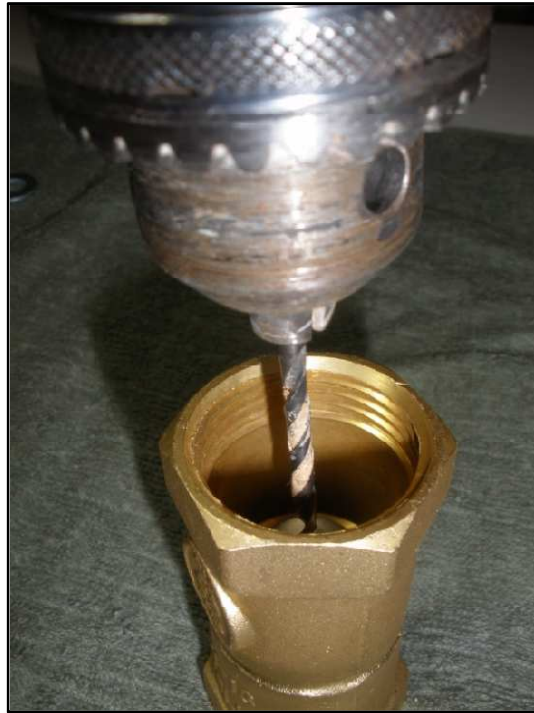
Figura AIII.4. Realizando la guía con la broca de 5 mm. [Fuente: Propia]
