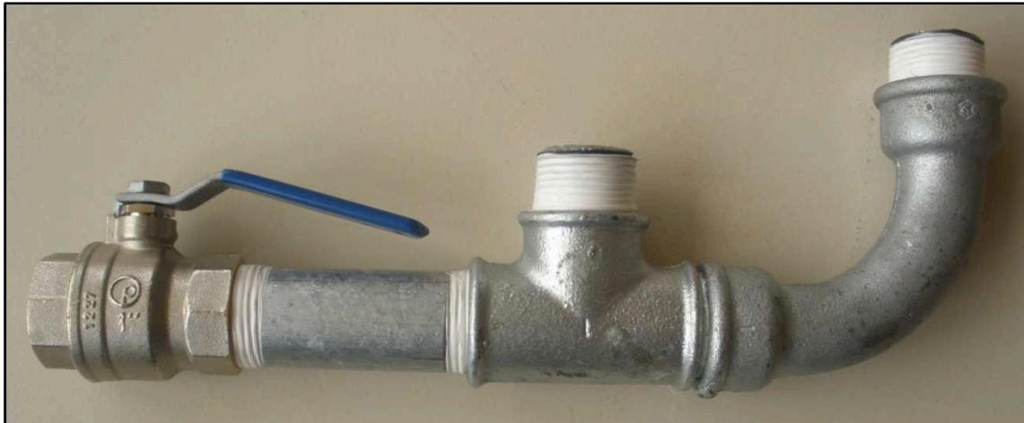
Figura Al.5. Cuerpo del ariete hidráulico con la llave [Fuente: Propia]
