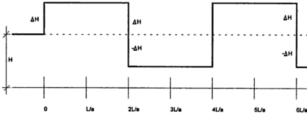
Figura 2.18. Evolución de la presión durante el transitorio en el punto O. (Aguas arriba de la válvula de cierre)
