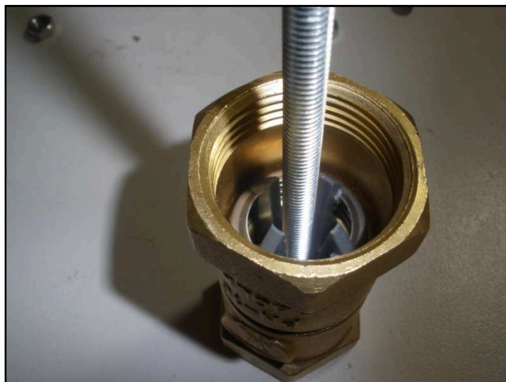
Figura AIII.7. Varilla de 6 mm. roscada por el agujero realizado [Fuente: Propia]
