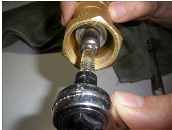
Figura AIII.8. Detalle de las arandelas, mientras se aprieta la tuerca [Fuente: Propia]
