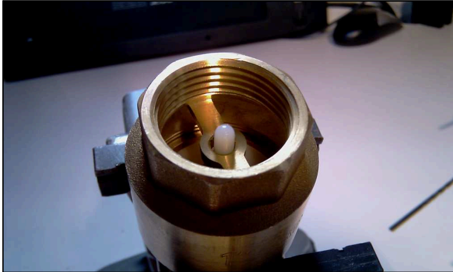
Figura AII.2. Lado por el que debe quedar sujeta la válvula no retorno [Fuente: Propia]
