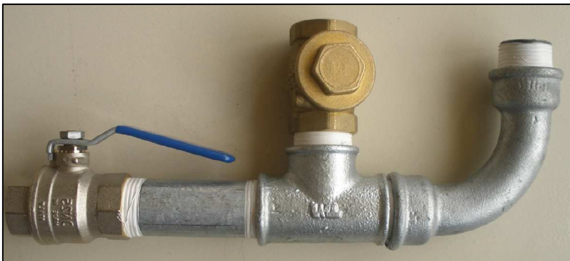
Figura Al.6. Válvula de descarga instalada sobre el cuerpo de la bomba de ariete [Fuente: Propia]
