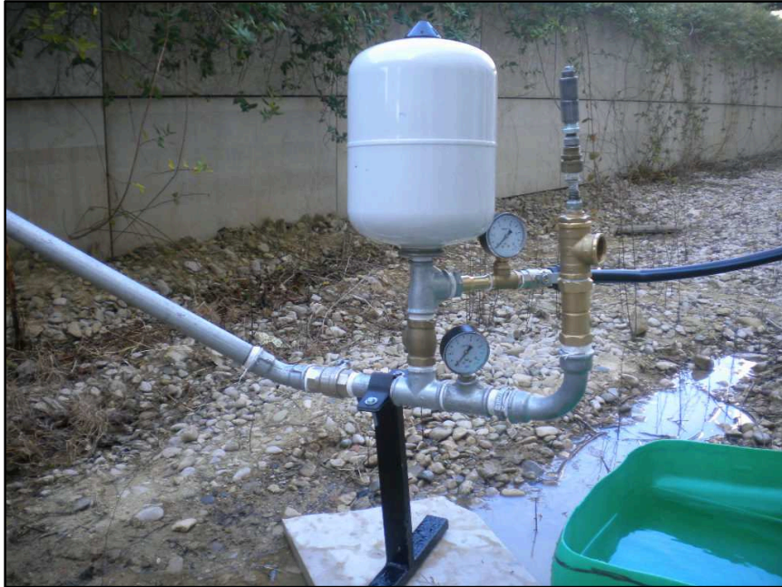
Figura 3.11. Bomba de ariete con los manómetros y la válvula de impulso tipo Kent [Fuente: Propia]
