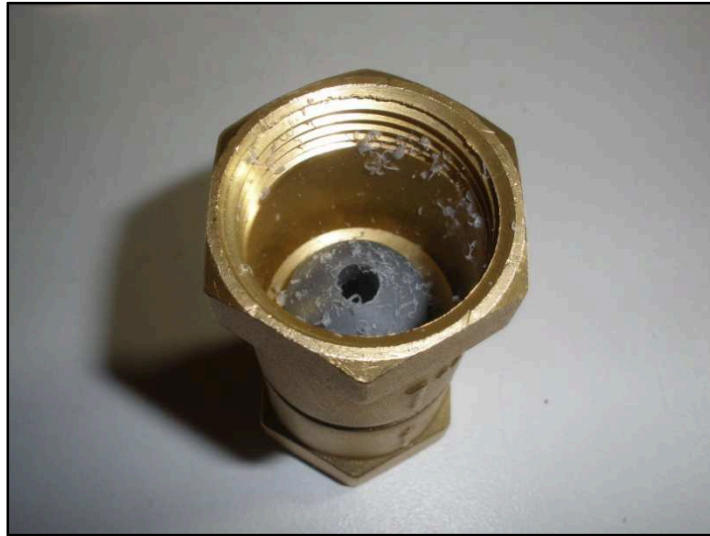
Figura AIII.6. Orificio final en la bola de la válvula no retorno [Fuente: Propia]
