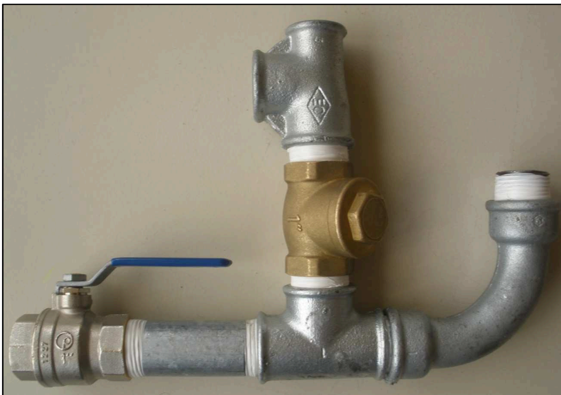
Figura A1.8. T reductora 1"-1"-3/4" acoplada encima de la válvula de descarga [Fuente: Propia]
