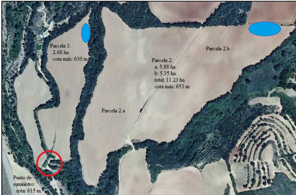
Figura 5.7. Parcelas, 1 y 2, para el bombeo de agua desde el punto de suministro [Fuente: Propia]
