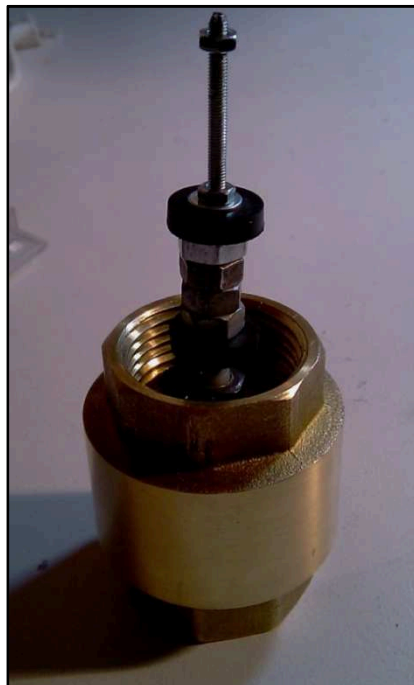
Figura 3.3. Válvula de impulso modificando una válvula no retorno tipo York [Fuente: Propia]
