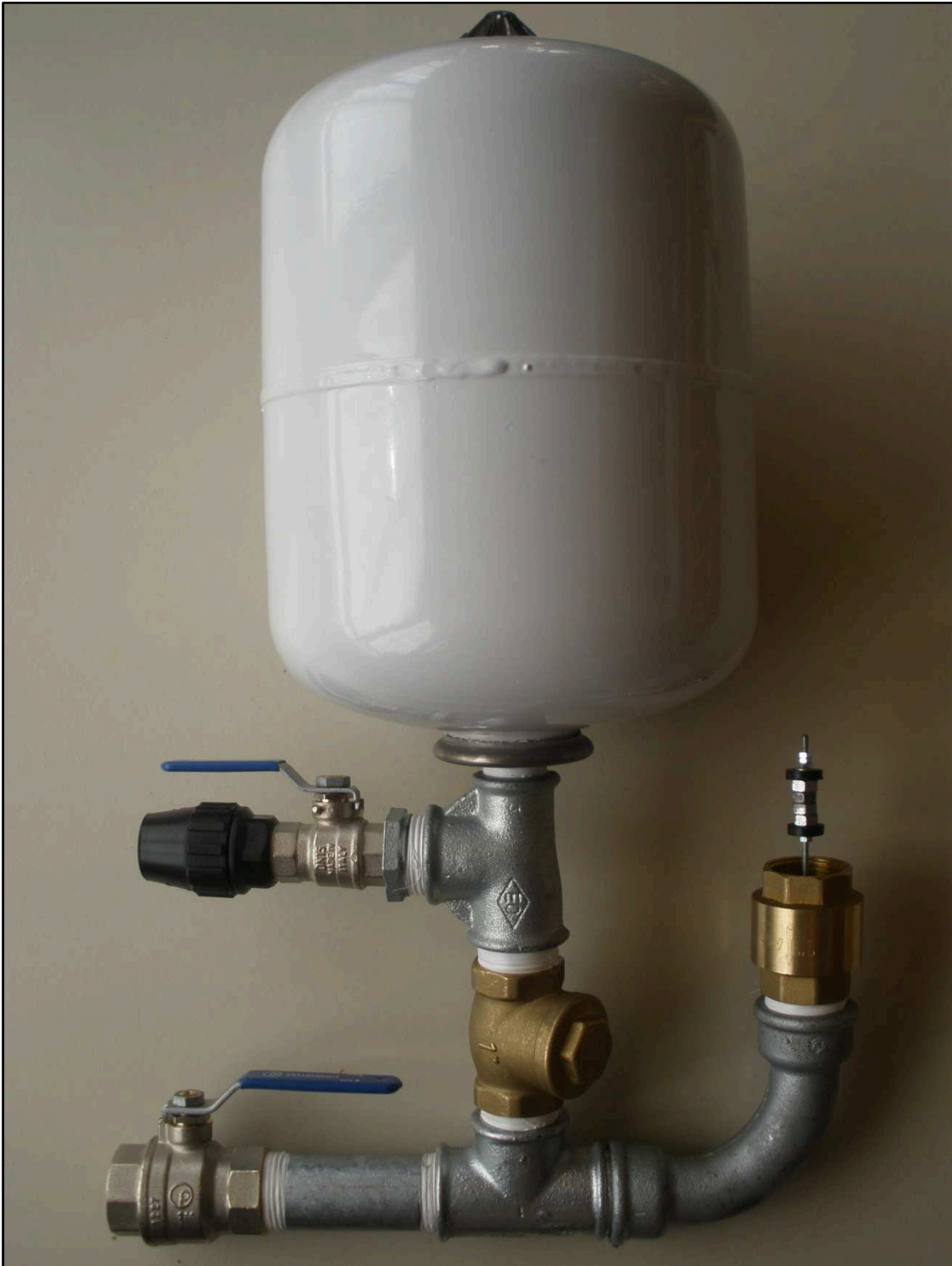
Figura A1.11. Construcción de la bomba de ariete finalizada [Fuente: Propia]
