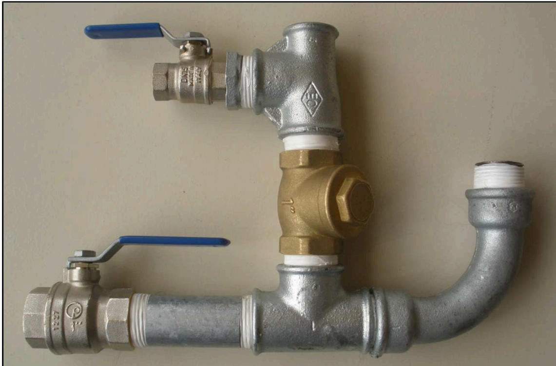
Figura AI.9. Salida de agua instalada para el bombeo [Fuente: Propia]
