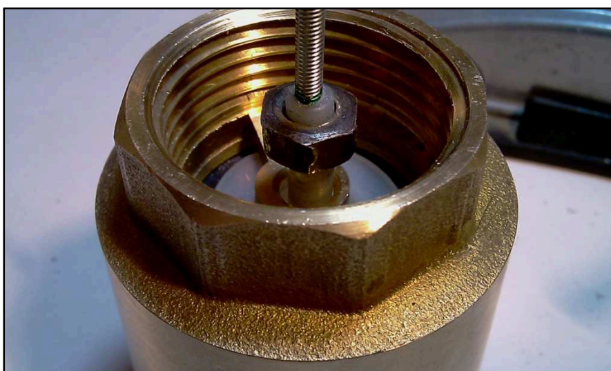
Figura All.15. Detalle de la tuerca que nos va a permitir modificar la carrera de la válvula de impulso. Válvula de impulso cerrada [Fuente: Propia]
