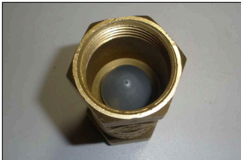
Figura AIII.2. Detalle de la bola de la válvula no retorno tipo kent [Fuente: Propia]
