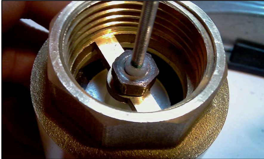
Figura All.16. Detalle de la tuerca que nos va a permitir modificar la carrera de la válvula de impulso. Válvula de impulso abierta [Fuente: Propia]
