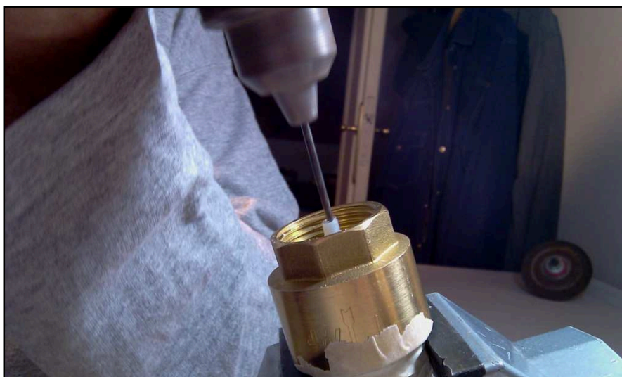
Figura AII.9. Realizando la guía con la broca de 3 mm [Fuente: Propia]
