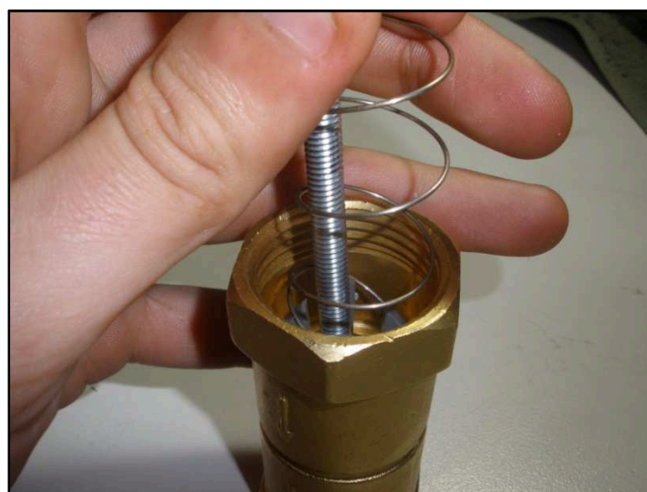
Figura AIII.9. Extrayendo el muelle de la válvula no retorno [Fuente: Propia]
