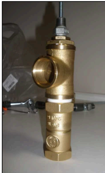
Figura 3.5. Válvula de impulso modificando una válvula no retorno tipo Kent [Fuente: Propia]
