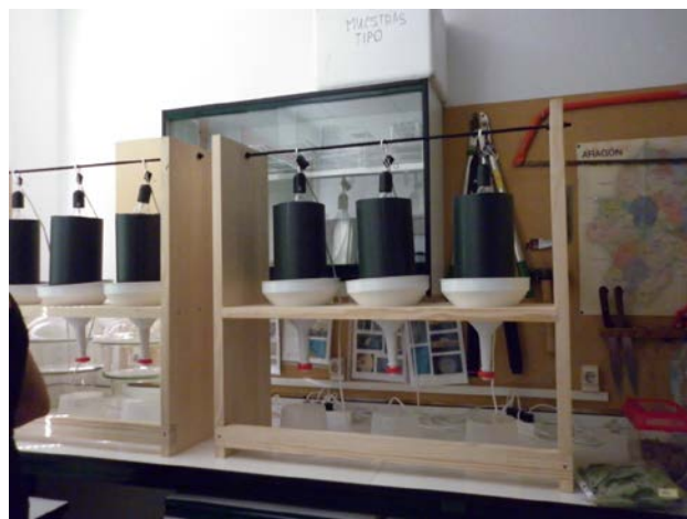
Figura 23: Fotos de los embudos Berlese utilizados en el ensayo
