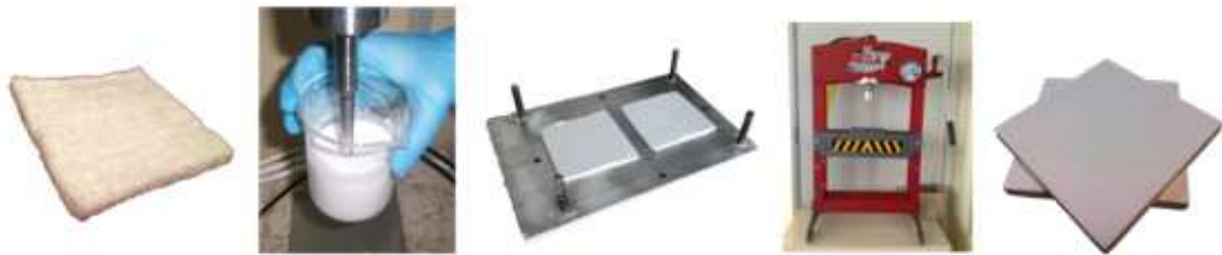
Figura 17: Imágenes de las etapas del proceso de obtención del material compuesto cerámico.
