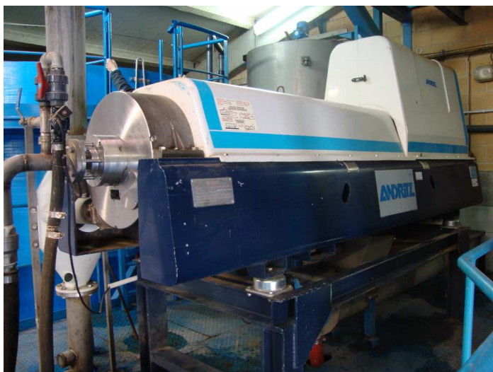
Figura 12. Centrifugadora de la planta para la separación de sólidos
