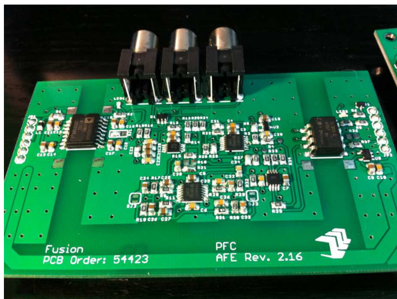
Figura 33. Interfaz analógica para captura y acondicionamiento de señales ECG.
