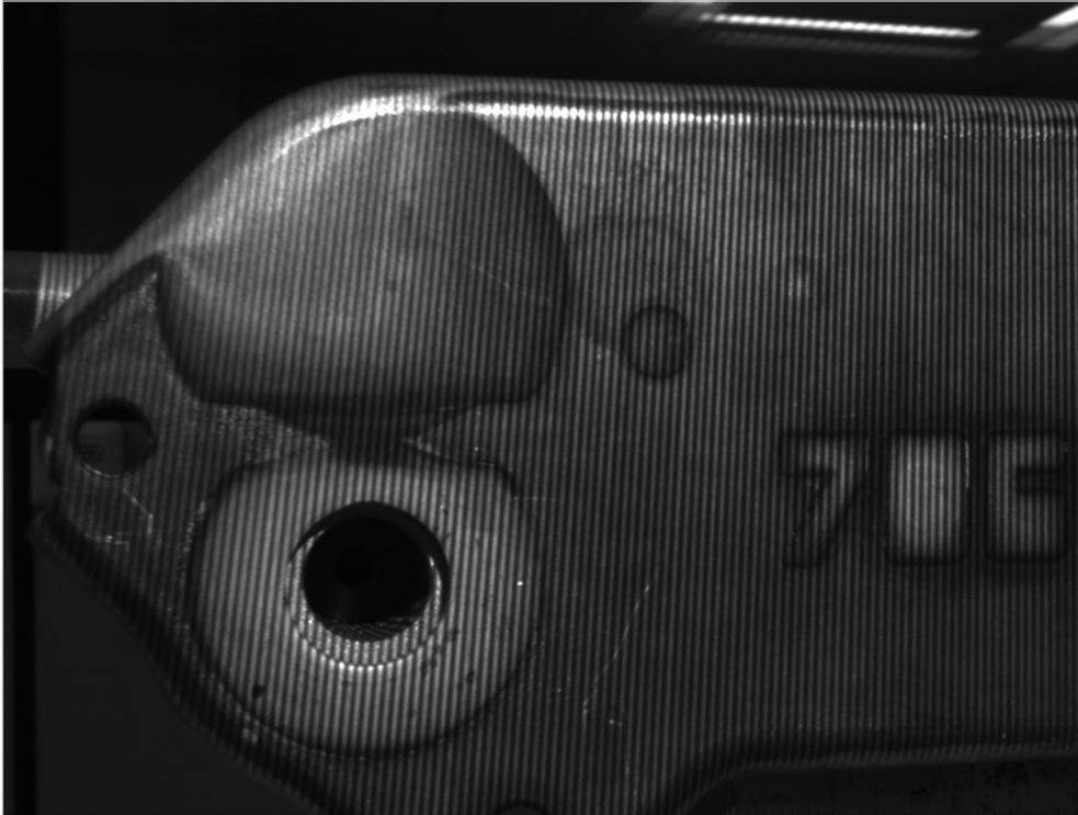
**Figura 4.23** - Deformación de las líneas producidas con el giro del Proyector 1
