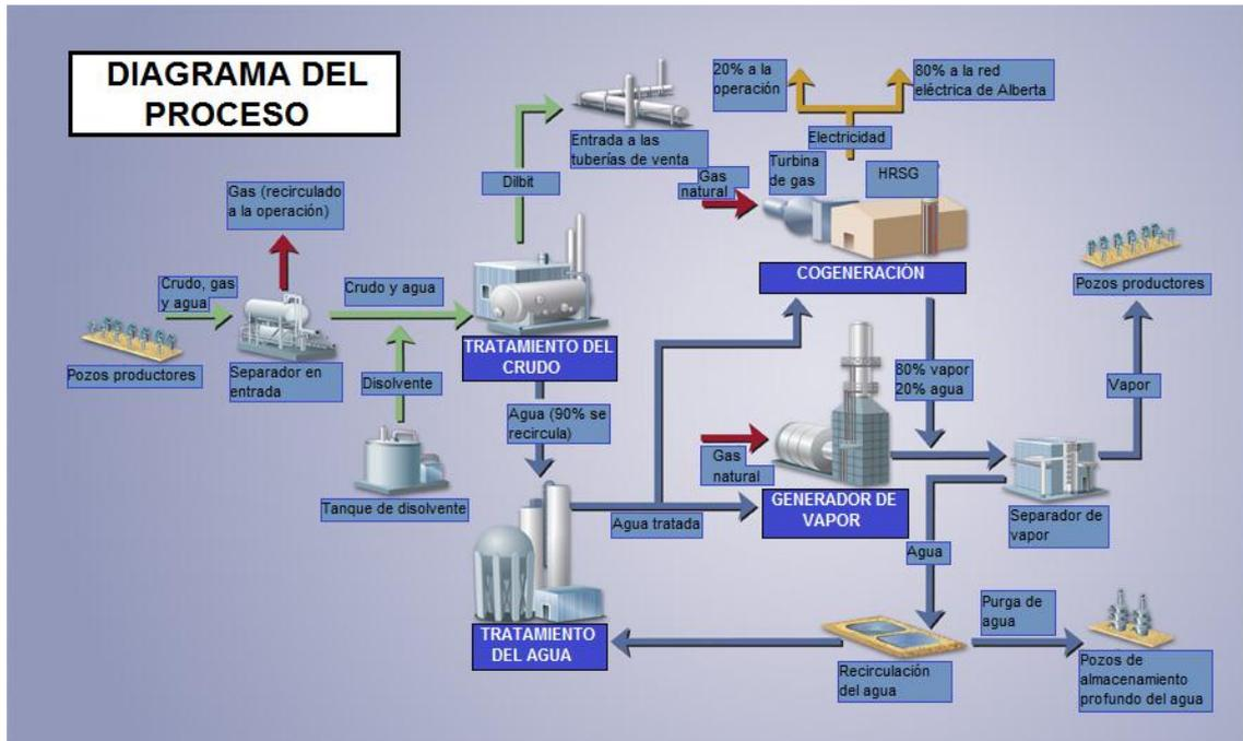
Figura 4. Esquema del proceso general de una planta SAGD (MEG energy corp.). Adaptado de [13]
